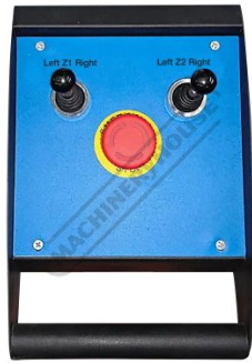
Z1 Z2 Motorised back gauge finger controls
