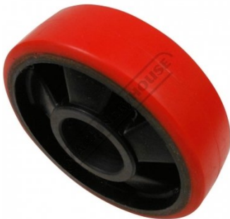
PK300 FIXED WHEEL 300 500KG OD 127 BORE 40 WIDTH 36
